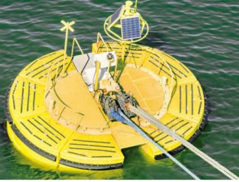
受客戶指示，某驗船師對一個浮筒的繫泊佈置計畫的合適性進行審查。該浮筒重250噸、直徑12米，最終將供那些在偏遠港口裝載鐵砂的船舶使用。
